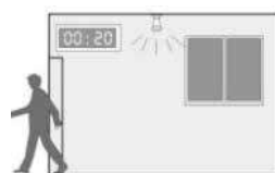
人走後進入守候狀態，守候亮度時，有運動，恢復全亮，重新計時
